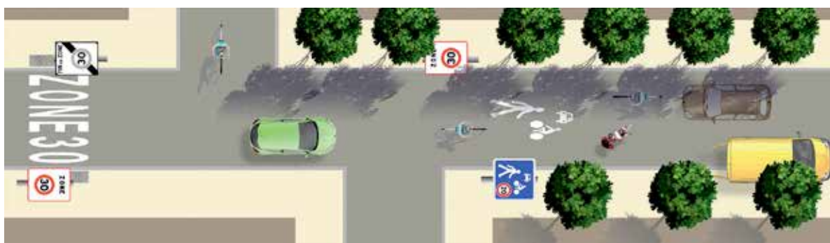
Signalisation de transition zone 30 - zone de rencontre : entrée de zone 30 par panneau seul, entrée de zone de rencontre complétée par marquage
