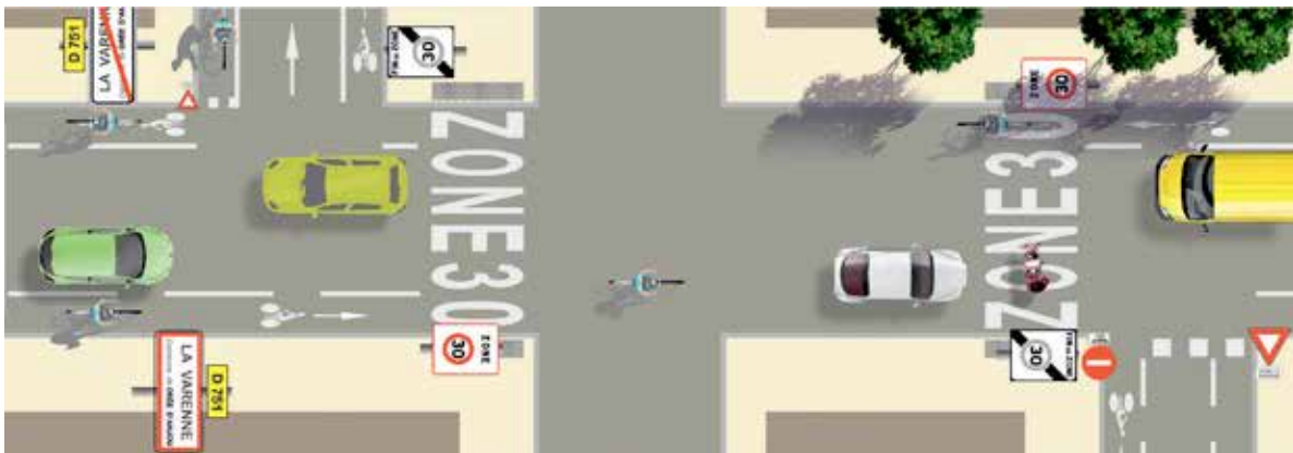
Signalisation d'entrées de zone 30 complétées par marquage
