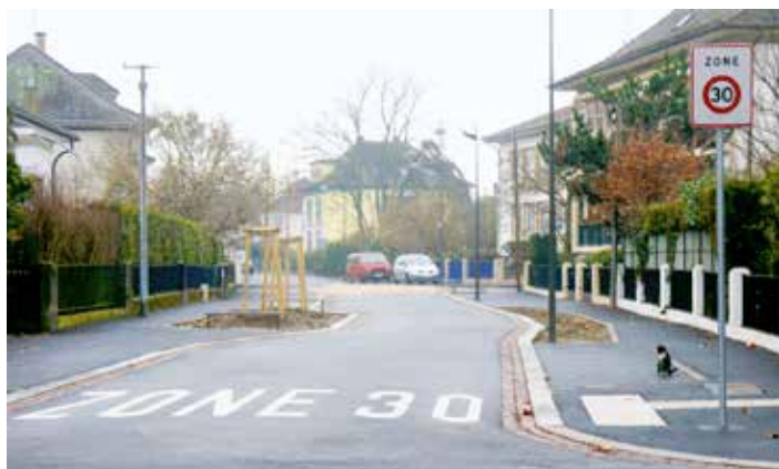
Signalisation d'entrée de zone 30 complétée par marquage
