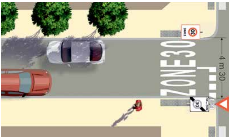
Signalisation d'entrée zone 30 : chaussée double sens de 4,30 m complétée par marquage
